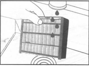
Поместите фильтр под проточную холодную воду до мокрой.
