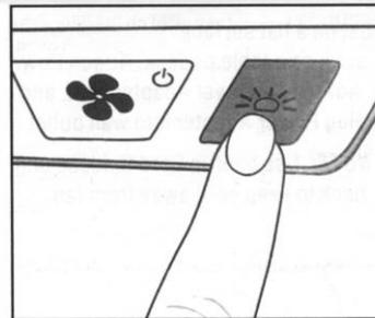
Чтобы выключить питание, нажимайте кнопку до тех пор, пока вентилятор не выключится (одно нажатие после низкой скорости), и световые индикаторы режима перестают светиться.
