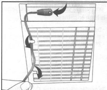
**ПРИМЕЧАНИЕ.** Используйте встроенную направляющую для шнура, чтобы держать шнур вдали от вентилятора.
